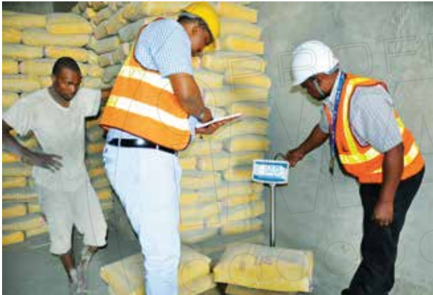
Uhakiki wa uzito wa mifuko ya saruji (cement)
